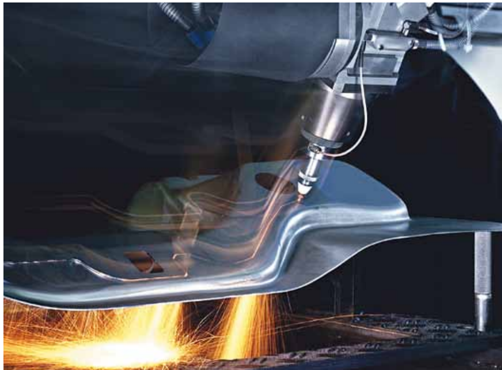
Kuva 1. 3D-laserleikkaus on joustava tapa rajata kuumamuovattuja korkealujuusteräksiä. Leikkausterät eivät kulu eikä työkalupalaiseen synny jännityksiä.
