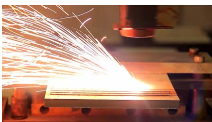
Kuva 1. Voimakasta roiskeiden syntyä hitsattaessa rakenneterästä kuituvälitteisellä laserilla.
